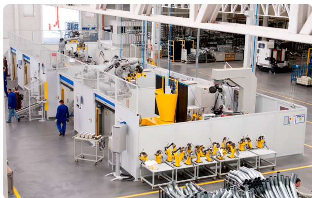
Linha de soldagem robotizada
